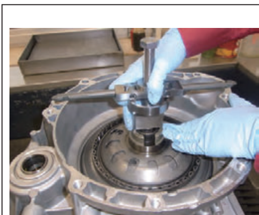
9. 将离合器专用工具的夹钳卡入卡槽下的花键
