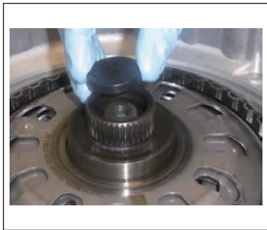
11. 水平放置新的离合器油封
